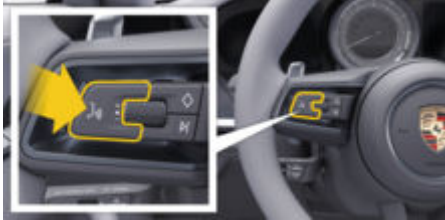
图 2: 方向盘上的语音控制按钮
